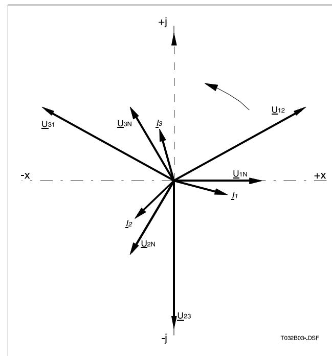
Vektory napětí a proudů; úhel vzhledem k vztahné ose X; (úhel se měří proti směru hodinových ručiček)
