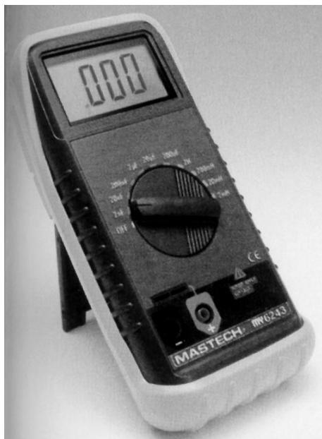
Digitální měřič kapacit a indukčnosti Mastech M 6243A umožňuje měřit indukčnosti na rozsazích 2mH až 2H a kapacity kondenzátorů v šesti rozsazích od 2nF do 200 $\mu$ F. Naměřené hodnoty se zobrazují na 3 1/2 LCD displeji. LC měřič M 6243A je napájen 9V baterií, uplatnění nalezne především v oblasti servisních měření.
