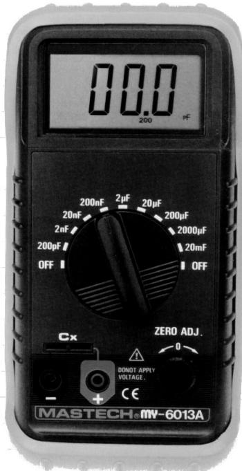
Digitální měřič kapacity Mastech M 6013A měří kapacity kondenzátorů v devíti rozsazích od 200pF do 20mF. Naměřené hodnoty se zobrazují na 3 1/2 LCD displeji. L měřič M 6013A je napájen 9V baterií.
