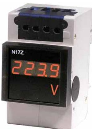
Přístroje typové řady N17Z jsou určeny pro měření střídavého napětí, proudu a kmitočtu do 500 Hz. Přístroj měří True RMS (s konstantní stejnosměrnou složkou), nebo jen střídavou složku. Je vhodný pro měření se stejnosměrnou složkou, přístroj měří: ac signál (konstantní stejnosměrná složka je nulová) ac, dc signál nebo dc signál (s konstantní složkou, která není nulová)
