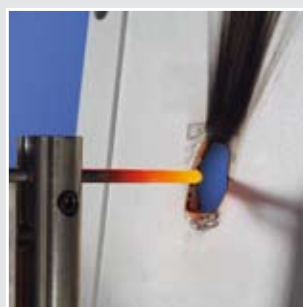
Zkouška žhavou smyčkou podle IEC 60 695-2-11: 750° C, těžce hořlavé, samozhášivé.
