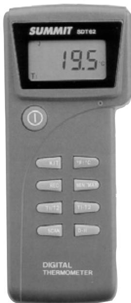
Mikroprocesorem řízený digitální teploměr SDT 62 měří v rozsahu teplot -250°C až 1375°C (-418°F až 2 507°F) podle připojené vnější sondy typu K, J nebo T. Monitoruje teplotu ve dvou zónách (T1 a T2), vypočítává teplotní rozdíly mezi dvěma sondami umístěnými v těchto zónách, zaznamenává minimální a maximální hodnoty a aktuální hodnotu (DATAHOLD). V módu SCAN cyklicky zobrazuje teploty T1, T2 a dále jejich rozdíl T1 - T2. Má indikaci nepřipojené sondy a nízkého napětí baterie.
